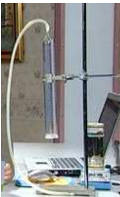
บับเบิลมิเตอร์ อุปกรณ์ในการสอบเทียบ โดยใช้น้ำสบู่
