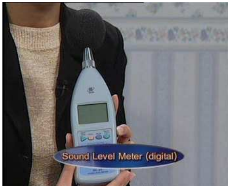
Sound Level Meter (digital) เครื่องมือตรวจวัดเสียง ชนิดดิจิทัล
