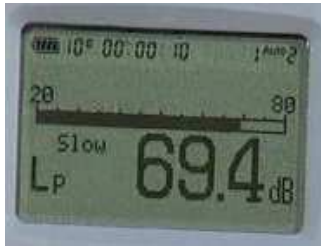
ตัวอย่าง ตั้งค่าการวัด 10 วินาที ย่านการวัด 20-80 dB ได้ค่า 69.4 dB Slow (ใช้ช่วงปกติ)
