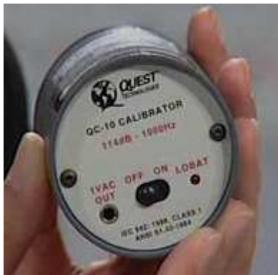
114dB - 1000 Hz เครื่องนี้ จะปล่อยความถี่ 1000 Hz และให้ความดัง 114 dB
