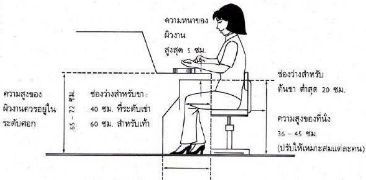
ภาพที่ 12.25 ข้อกำหนดการออกแบบส่วนต่างๆสำหรับงานนั่ง
