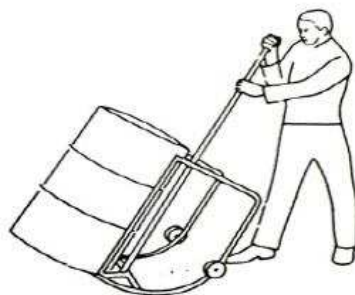
ภาพที่ 12.45 ข ตัวอย่างของเทคนิคในการเคลื่อนย้ายถังกระบอกขนาดใหญ่ ด้วยการขีดล้อ ส่วนบนให้ตรงขณะทำงาน และใช้อุปกรณ์ทุ่นแรงในการเคลื่อนย้าย
